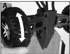
A Tournez les roues arrière lentement jusqu'à ce que l'arbre de sortie est en place.
